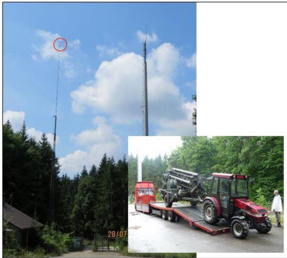
Abbildung 7: Untersuchungsaufbau zur Messung der Fledermausaktivität mittels eines Aufnahmegerätes ( batcorder , ecoOb GmbHs) in 40 Metern Höhe (Foto li.) und Anlieferung des Teleskopgittermasts (Foto re.).
